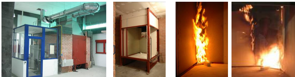
Figura 1: Aspectos do equipamento e do ensaio SBI [5]
